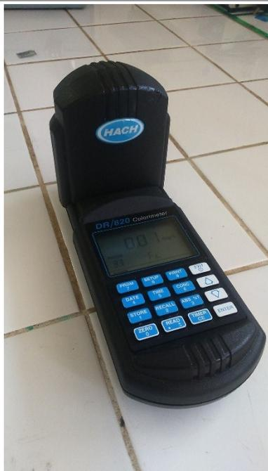
Mesure du taux de fer contenu dans l'échantillon après tarage du spectrophotomètre
