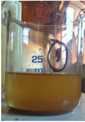
Après dissolution à l'eau, on obtient la solution verte caractéristique du Ferrate IV/Ferrate V
