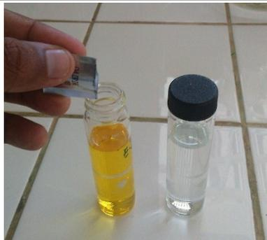
Prise de 25 ml d'échantillon et préparation d'un échantillon à blanc
