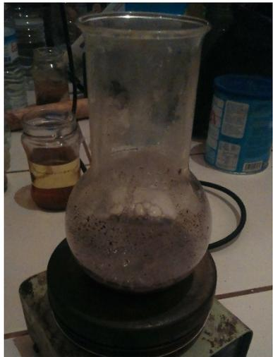
Le mélange est chauffé avec modération sur une plaque chauffante entre 50°C à 55°C pendant au moins 20 minutes
