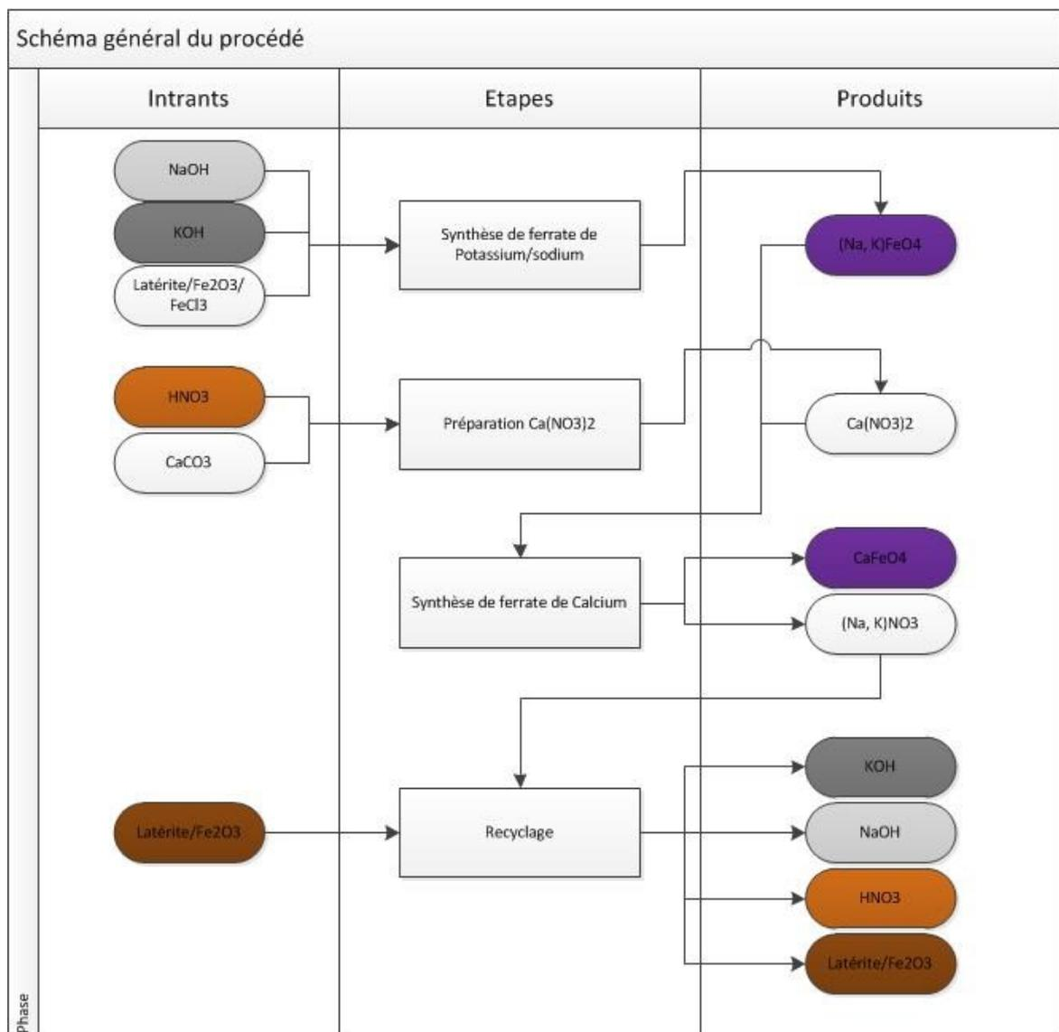
**Figure 6-1 : Schéma général du procédé avec recyclage de produits**
