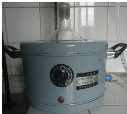
Figure 12 : Chauffe-ballon + ballon (Cliché AUTEUR, 2016)
