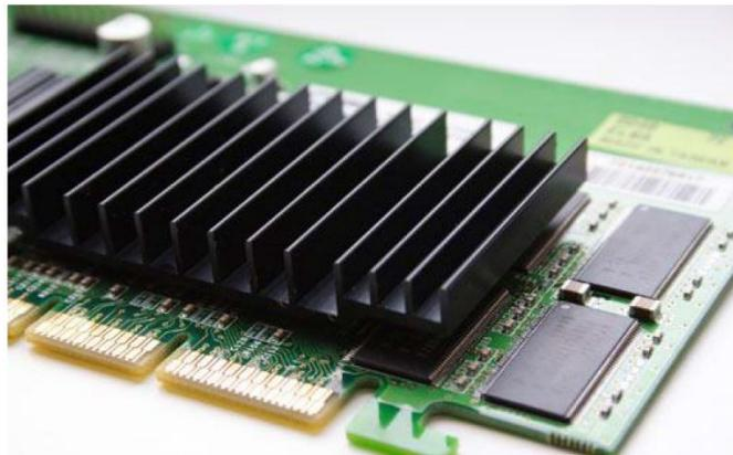
**Figure 2. 2:** Le dissipateur thermique
