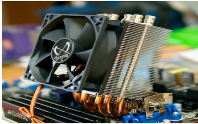
**Figure 2. 33:** Dissipateur thermique avec un ventilateur et un tube à chaleur
