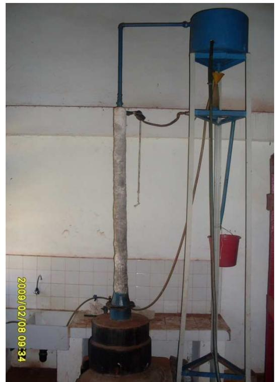
Figure 30 : Installation du rectificateur
