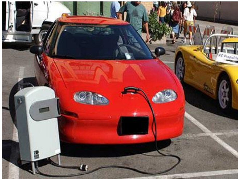
FIGURE 1.12 – Véhicule General Motors EV1 avec une batterie Pb-acide.
