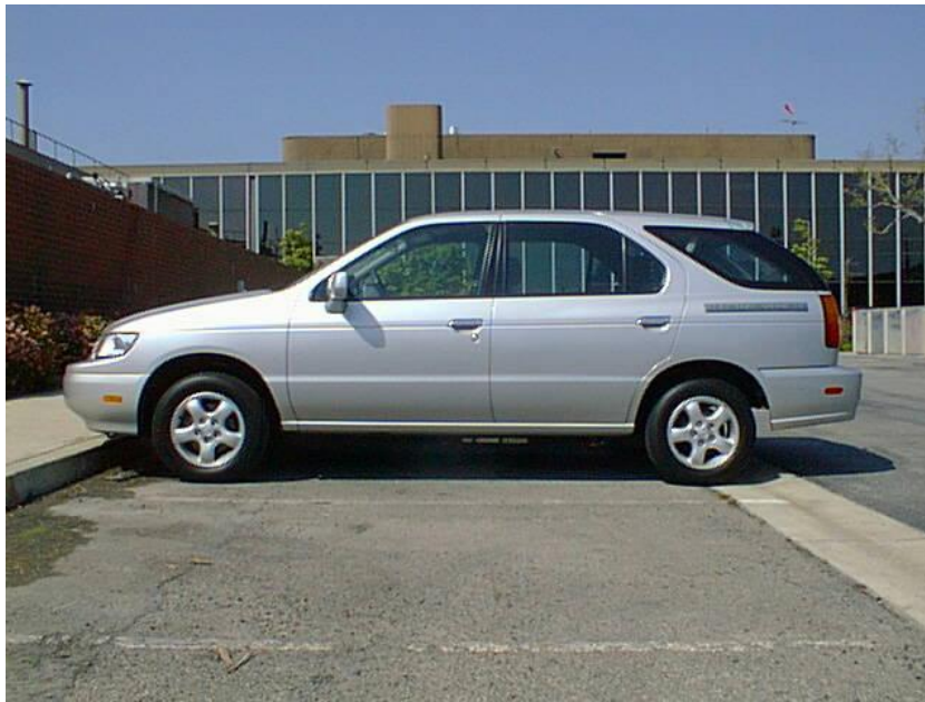
FIGURE 1.13 – Véhicule Nissan Altra avec une batterie Lithium-ion.
