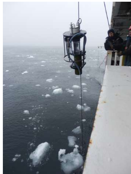
FIGURE 4.5 – Pompe in situ McLane (à gauche) et pompe in situ Challenger (à droite) lors de la campagne GEOVIDE (photo Pascale Lherminier).
