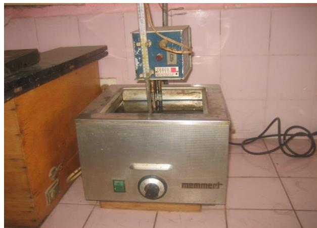
Photo 3 : Bain thermostatique pouvant tenir la température à 25°C
