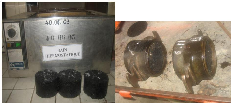
Photo 15 : Eprouvette pour l'essai Marshall
