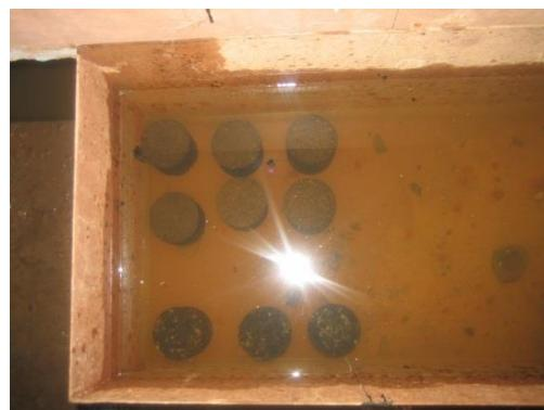
Photo 20 : Conservation à l'immersion de l'éprouvette dans la chambre froide
