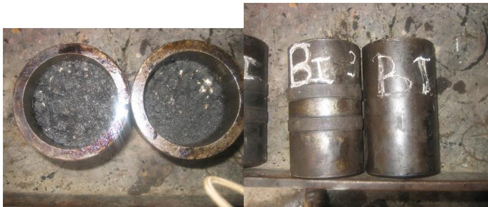
Photo 16 : Confection de l'éprouvette pour essai duriez
