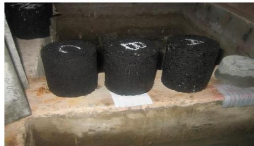
Photo 18 : Conservation à l'air de l'éprouvette dans la chambre froide
