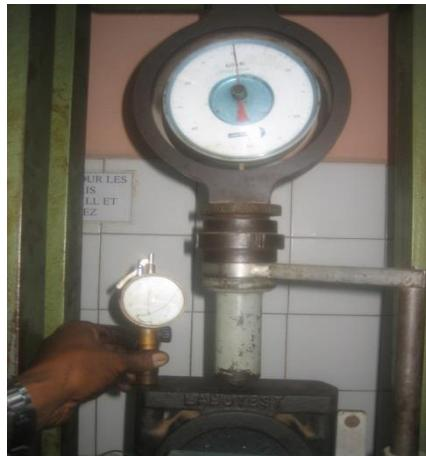
Photo 14 : Essai Marshall et mesure de fluage
