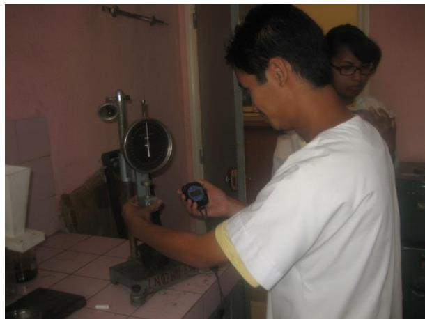
*Photo 6 : Exécution de l'essai de pénétrabilité*
