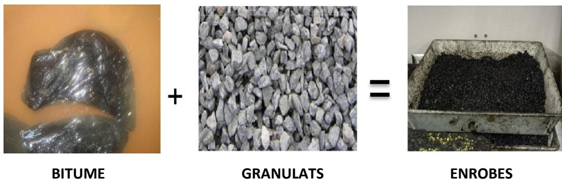
Photo 11 : Mélange EB 0/14 avec bitume pur
