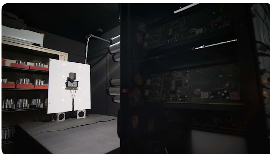
FIGURE 3.3 – Photo du banc de test BTFFPM2 (vue de derrière). Voir Figure 3.1 pour les différents éléments le constituant — à gauche, les 8 LEDs NSB sont allumés et le Flash LED Pulser est au centre — à droite, nous pouvons apercevoir deux modules (voir Figure 2.6 pour plus de détails sur le module) (©photo A. Tsiachina, IRAP).
