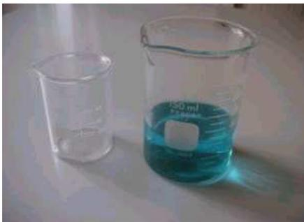
Un bêcher est un récipient cylindrique à fond plat, au bord haut légèrement évasé et muni d'un bec verseur. Il est aussi appelé vase de Berlin ou berlin (en Belgique surtout). Ce récipient est utilisé dans les laboratoires de chimie, physique, biologie, pharmacie...
