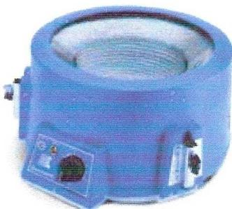
Le chauffe-ballon est, comme son nom l'indique, un instrument qui permet de chauffer les ballons. Il se présente généralement sous la forme d'un rectangle sur la surface duquel on aurait creusé une demi-sphère. Il est très utilisé pour les montages à reflux.
