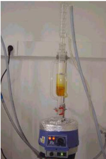
Un extracteur de Soxhlet (ou appareil de Soxhlet) est une pièce de verrerie utilisée en Chimie analytique qui permet de faire à chaud l'extraction par solvant d'un solide avec une grande efficacité. Cet appareil porte le nom de son inventeur : Franz von Soxhlet.
