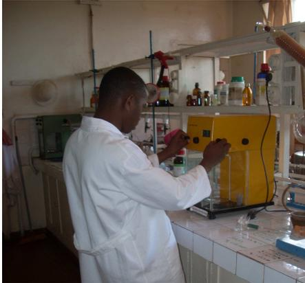
La balance de précision est utilisée en laboratoire pour mesurer le poids d'un produit lors de la préparation d'un réactif ou celui de l'échantillon.
