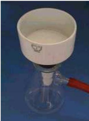
L'entonnoir Büchner est un équipement de laboratoire utilisé pour la filtration sous vide. Il est traditionnellement fait en porcelaine ou en verre fritté. Sur la partie haute de l'entonnoir, il y a un cylindre avec une partie plate perforée. Le matériel de filtration, souvent du papier filtre, est placé sur cette partie plate. Le liquide à filtrer est versé dans le cylindre et aspiré par un vide partiel créé dans la fiole à vide. Il porte le nom du chimiste industriel Ernst Büchner.
