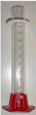
L'éprouvette graduée est utilisée en laboratoire pour mesurer des volumes de liquides.
