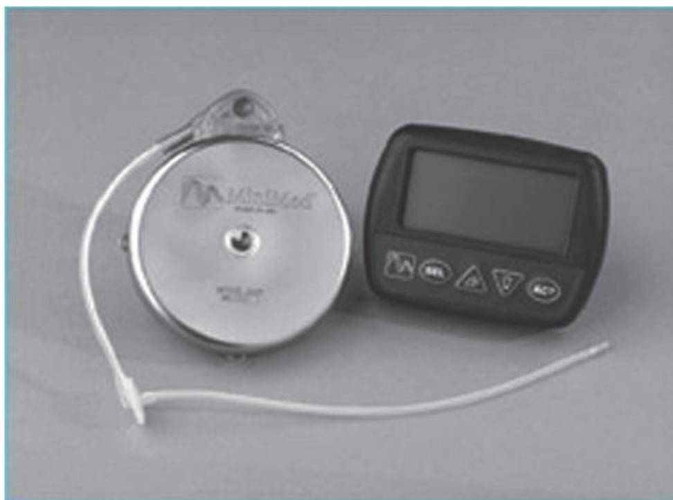
Figure 18 : Photographie d'une pompe implantable MiniMed [114]
