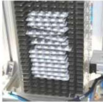
Figure 27 : **Système de stockage des blisters à découper du module Attis**
