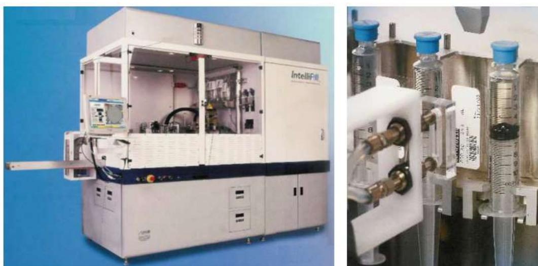
Figure 16 : Automate INTELLIFILL IV® de Baxter et seringues produites par l'automate
