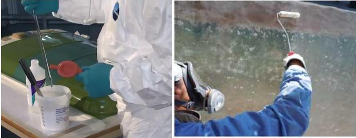
*Figure 14: Mélange du catalyseur et du gelcoat et application sur le moule.*
