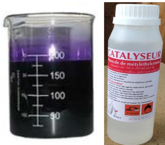
Figure 11: Accélérateur et catalyseur.
