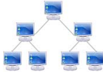
Figure 1.4 : La topologie physique en arbre
