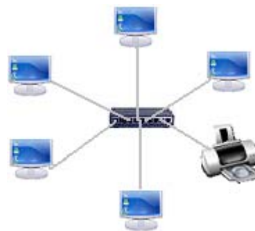
Figure 1.2 : La topologie physique en étoile
