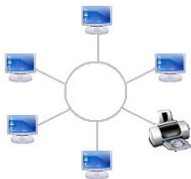
Figure 1.1 : La topologie physique en anneau
