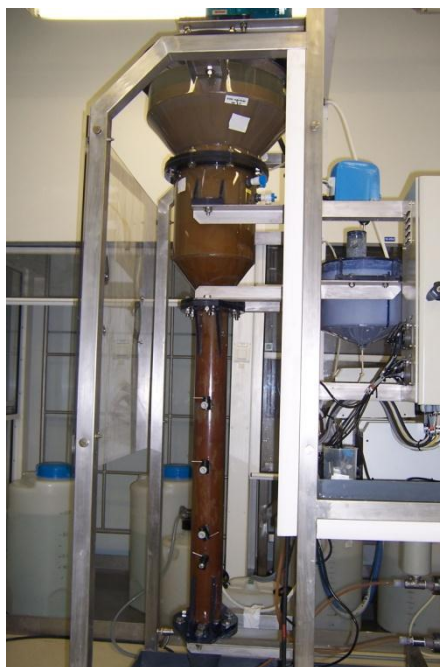
Figure 1.14 : Photographie du réacteur à lit fluidisé. La couleur marron correspond à la boue de fluorine formée pendant l'expérience.
