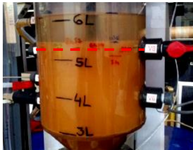
Figure 6.8 : Photo prise pendant que le lit des particules (boue) est au-dessus du niveau de la vanne de recirculation.
