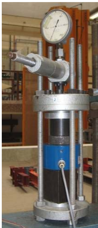
Figure 68 : Etalonnage du bâti de fluage en compression
