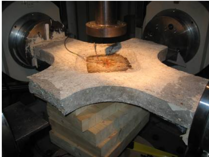
Figure 210 : éprouvette « uniaxiale » instrumentée.
