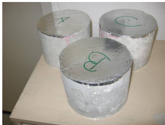
Figure 82 : Eprouvettes de mesure de la perte de masse.
