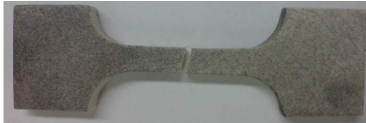
Figure 64 : Rupture de l'éprouvette.
