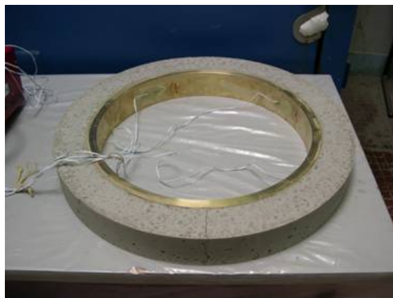
Figure 46 : Dispositif expérimental à l'anneau [9]
