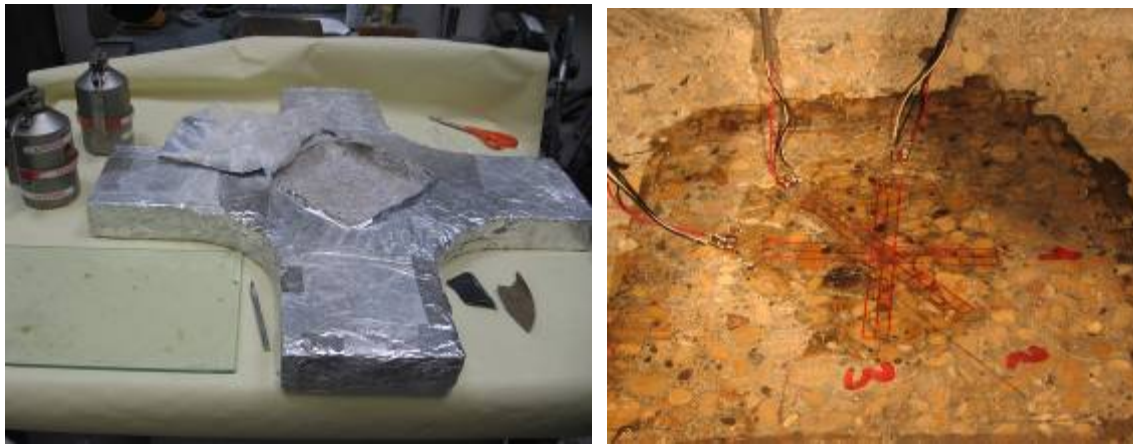
Figure 208 : Collage des jauges : préparation et résultat
