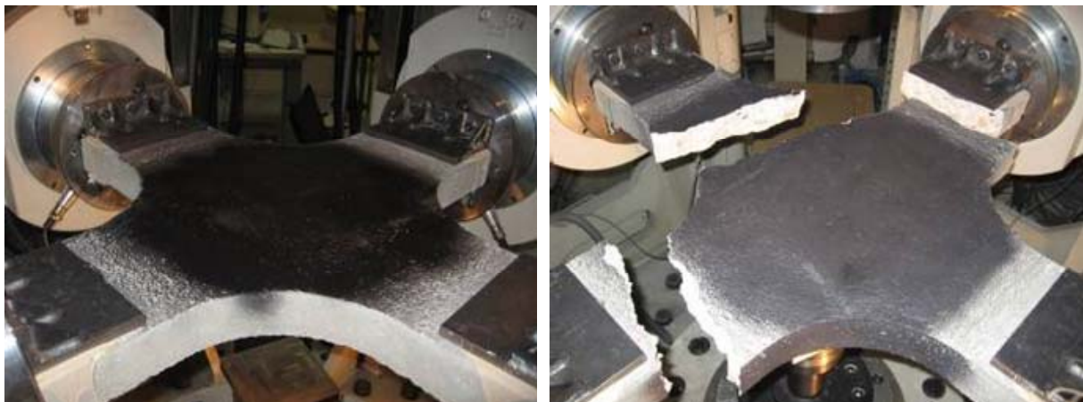
Figure 205 : Test avec une éprouvette non usinée.
