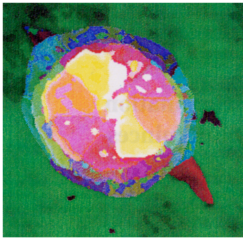
Fig. 1.24: Cartographie ultrasonore - documentation Aérospatiale
