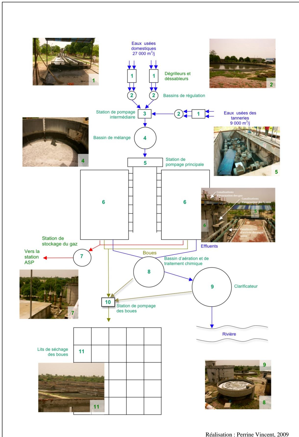
Schéma 4 – la station UASB de 36 000 m<sup>3</sup>/j et le post traitement, Kanpur
