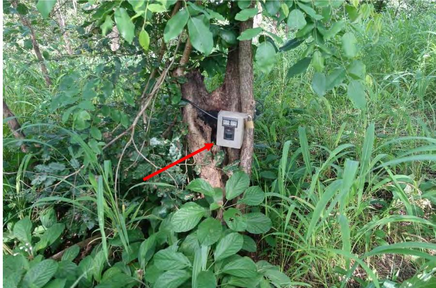
**Figure 10 : un piège photographique placé sur un tronc d'arbre**
