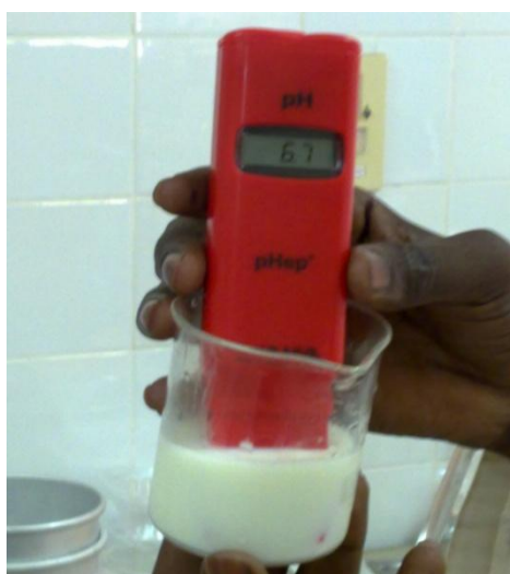
Figure 1: Mesure du pH du lait (photo Mallaye)
