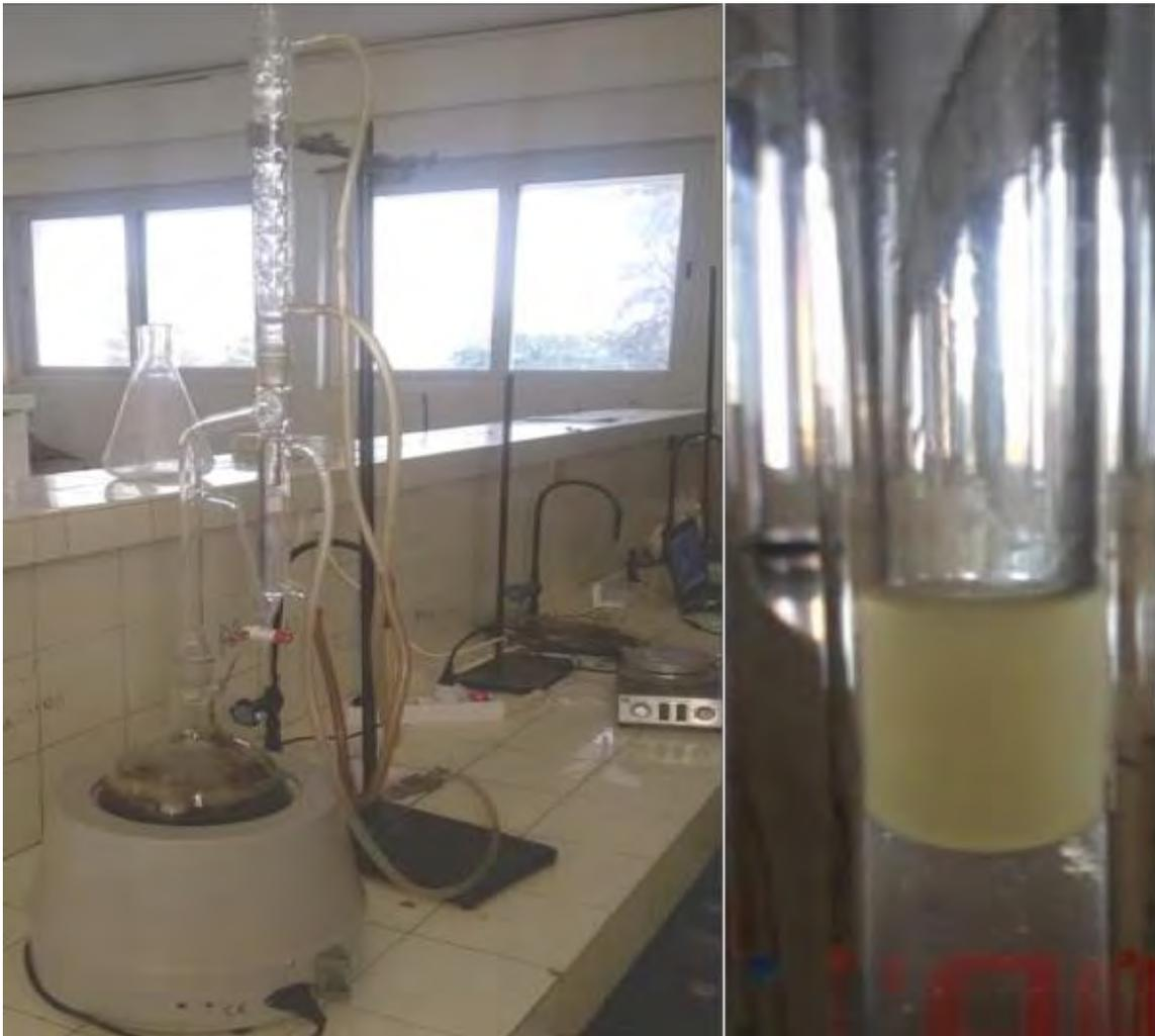
**Figure 3 : Hydrodistillation à l'aide d'un système de type Clevenger**
