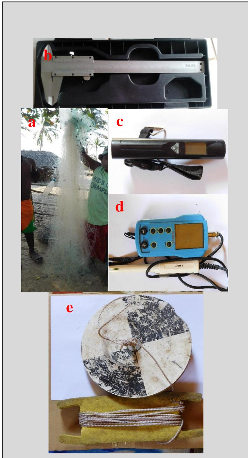
**a** = filet maillant ; **b** = pied à coulisse ; **c** = balance électronique ; **d** = HI 9812-5 (pH-mètre, thermomètre, conductimètre); **e** = disque de Secchi (Photo : ANDRIAMAVOSOLOARISOA, 2017)
