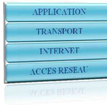
*Figure 1.3 : Modèle TCP/IP*
