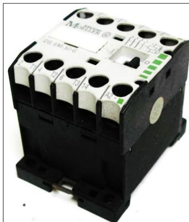
**Figure 17 : Contacteur moeller DIL EM 10 G**
