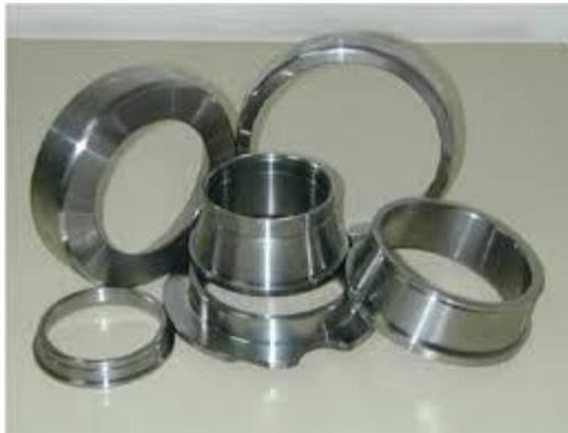
Fig.13 Pièce trempé martensitique [W12]
