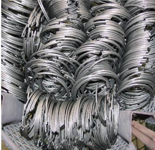
Fig15 Pièce trempée austénitique [W14]
