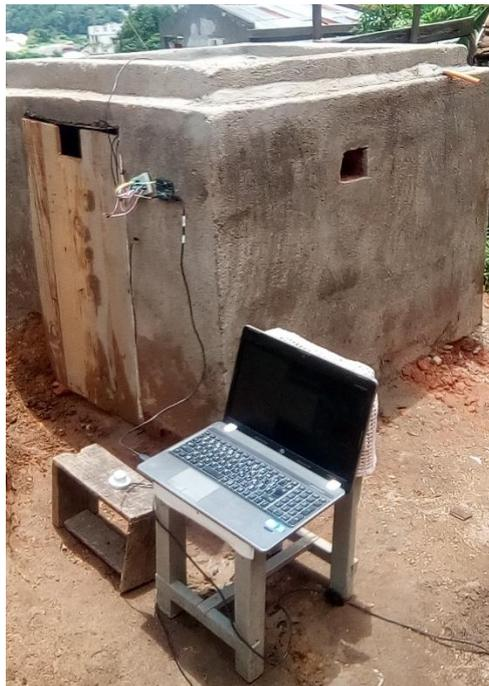
**Figure II.11** : Photo représentative de la cellule cubique avec tous les appareils de mesure
