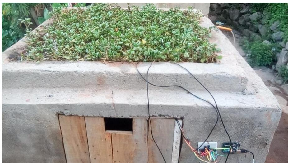
**Figure II.12** : Photo de la cellule cubique de toiture végétalisée de cresson
