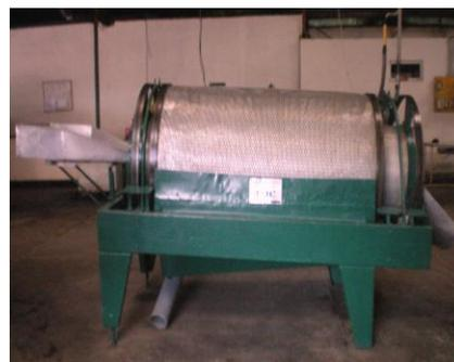
**Figure 6 : Laveuse - calibreuse cylindrique à rampes d'aspersion (Cliché : auteur, 2011)**
