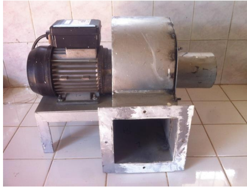
Figure N° 15: Le ventilateur centrifuge et moteur utilisés dans notre installation
