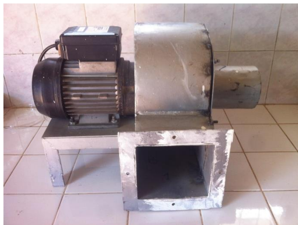
Figure N° 23: Unité de ventilation
