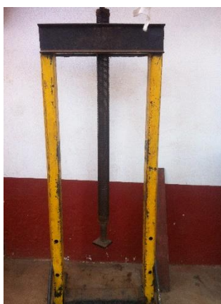
Figure N° 36: Presse à vis sans fin chez PRONAMA
