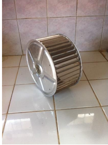
Figure N° 21: Ventilateur centrifuge et ses aubes [Auteur]
