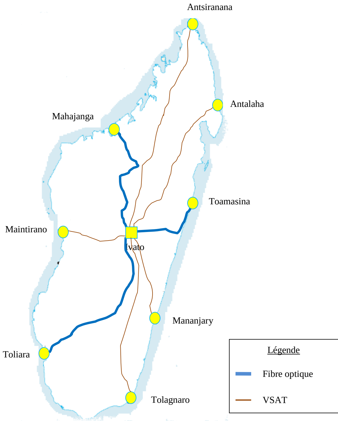
Figure 5.05: Nouvelle architecture VSAT/fibres optiques de l'entreprise
