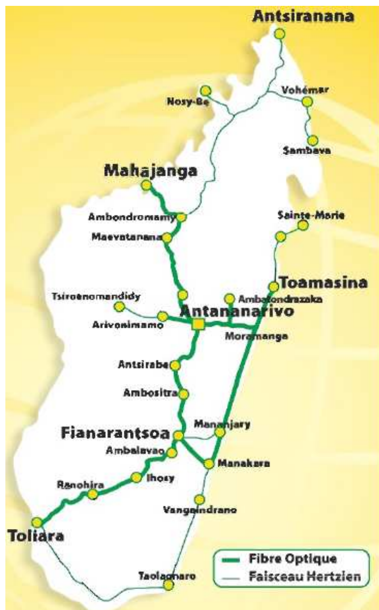
Figure 5.01: Le backbone national en fibre optique de l'opérateur à Madagascar [38]
