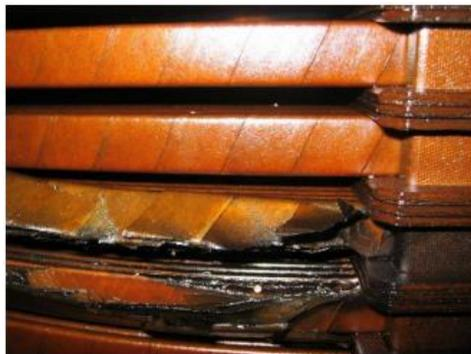
Figure II-1 : Amorçage diélectrique entre spire
