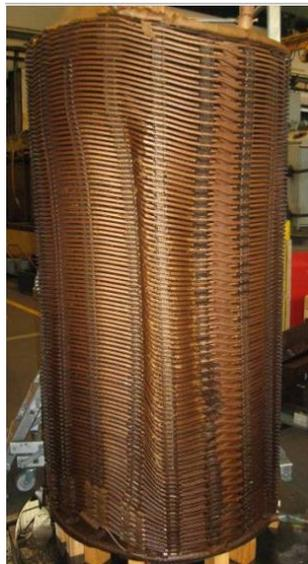
Figure II-4 : Déformation géométrique des enroulements
