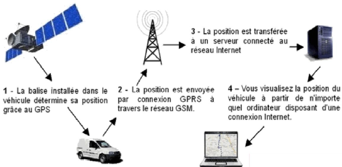
Figure 1.03 : Principe de la localisation d'un véhicule équipé d'un terminal embarqué
