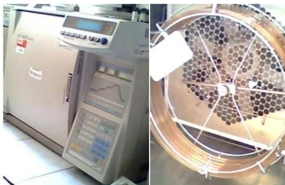
Figure 12 : Four (image à gauche) muni d'un pupitre de commande servant à programmer les conditions d'analyse et colonne capillaire (à droite) montée dans le four.
