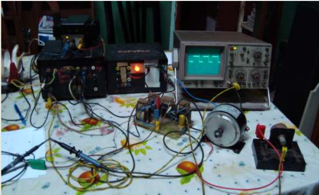
Figure 64 : Photo du banc d'expérimentation du hacheur à thyristors
