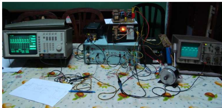
Figure 59 : Banc d'essai du hacheur
