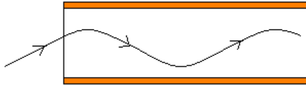
Figure 4: Fibre multimode à gradient d'indice
