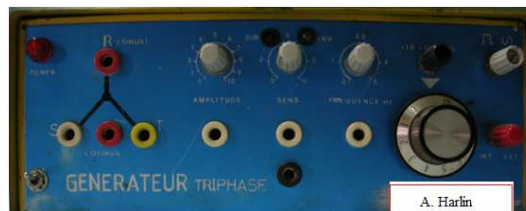
Figure 211 : Plaque frontale du Générateur BF triphasé
