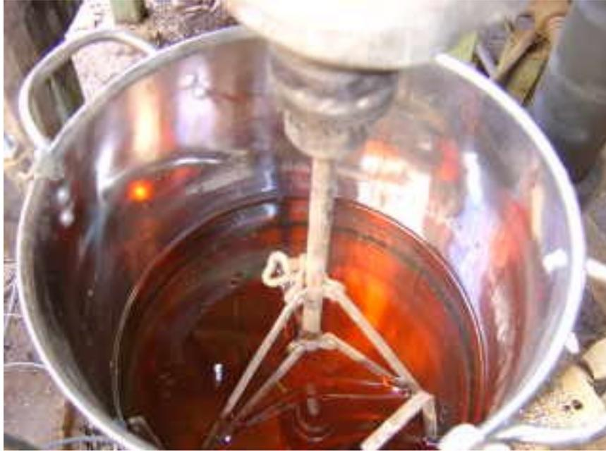
*Photo 1 : matériel pour l'estérification de l'huile : cuve en inox de 20 litres, arbre tournant à 900 rpm, mélangeur tripales*
