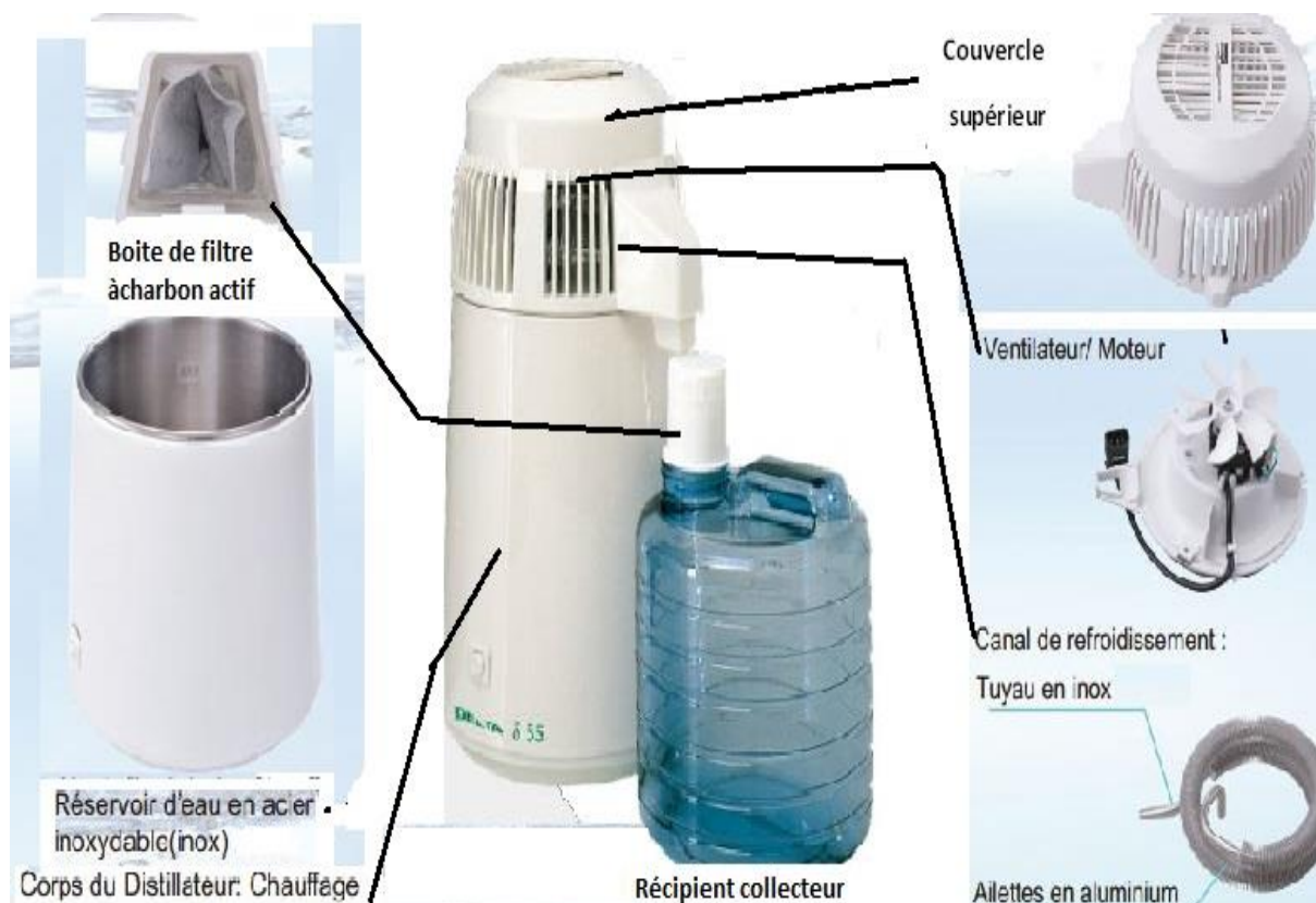
Figure 3 : Présentation détaillée d'un distillateur megahome
