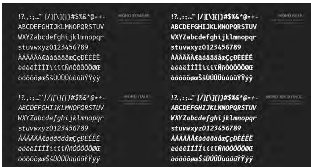
Figure 77 : Les 4 variantes de fontes AI-B612 à espacement monospace, Mono Regular, Mono Italic, Mono Bold et Mono BoldItalic
