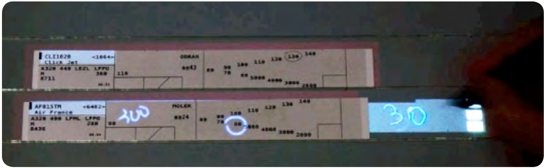
Figure 107 : Interaction avec le stylo Anoto de notation utilisant un principe d'extension sur le tableau de strips du strip papier par une partie virtuelle.
