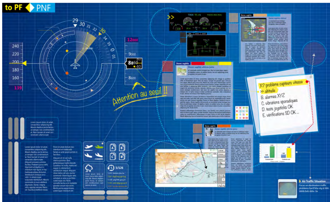
Figure 165 : Illustration numérique d'une composition libre des informations sur la zone PNF (Pilot Non Flying) de la surface interactive du cockpit pour explorer une solution à un problème de vol.
