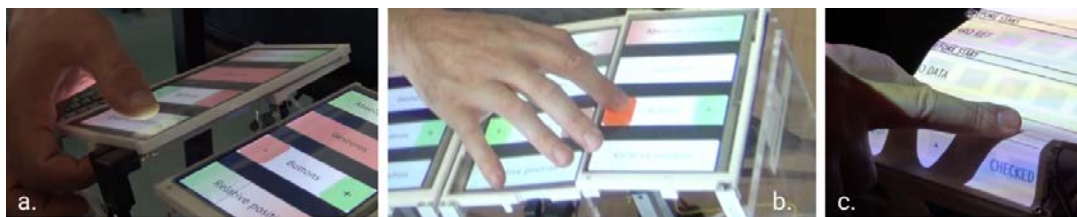
Figure 94. Interactions proposées par le système pour agir sur les plis : a) réglage de l'inclinaison avec le slider position relative ; b) Utilisation du bouton + et - ; c) action tactile sur le sommet d'un pli pour le replier
