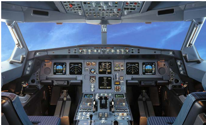
Figure 19. Deuxième génération de Glass Cockpit – Airbus A320
