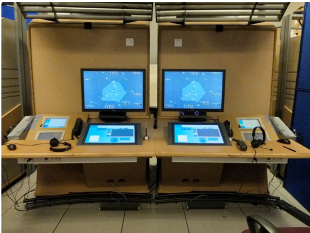
Figure 43 : position de travail Droid équipée d'oculomètres Tobii
