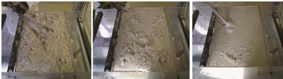
FIGURE III.13 – Etapes successives de l'homogénéisation de la pâte de silice avant une modélisation. Sur la première image on peut observer le résultat obtenu après le mélange préliminaire de la poudre de silice et l'eau. Sur la seconde et la troisième image on peut voir le résultat de l'homogénéisation. On obtient une pâte totalement lisse en fin d'homogénéisation.
