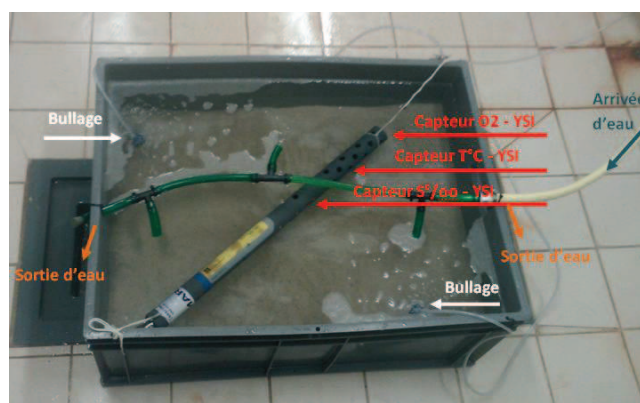
Figure 36. Dispositif expérimental mis en place pour la recherche d'un cycle endogène sur l'activité de 3 enzymes d'intérêt : la phénoloxydase, la superoxyde dismutase et la catalase chez la palourde japonaise. Les 2 systèmes de bullages sont disposés à chaque extrémité du bac et les arrivées en eau de mer filtrée sont réparties de façon homogène à la surface du bac. La sonde (YSI OMS 600 V2) est immergée à la surface du bac.
