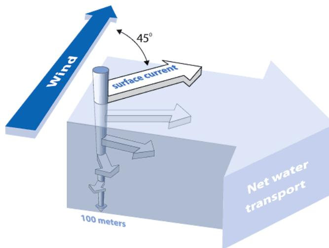
Figure 5a. Principe du transport d'Ekman, ©NOAA's National Ocean Service. Action du vent sur l'océan : le transport de la couche d'Ekman est perpendiculaire au vent, à droite dans l'hémisphère Nord, à gauche dans l'hémisphère Sud. Les vecteurs représentent, à chaque profondeur, la vitesse, la direction, et le sens du courant
