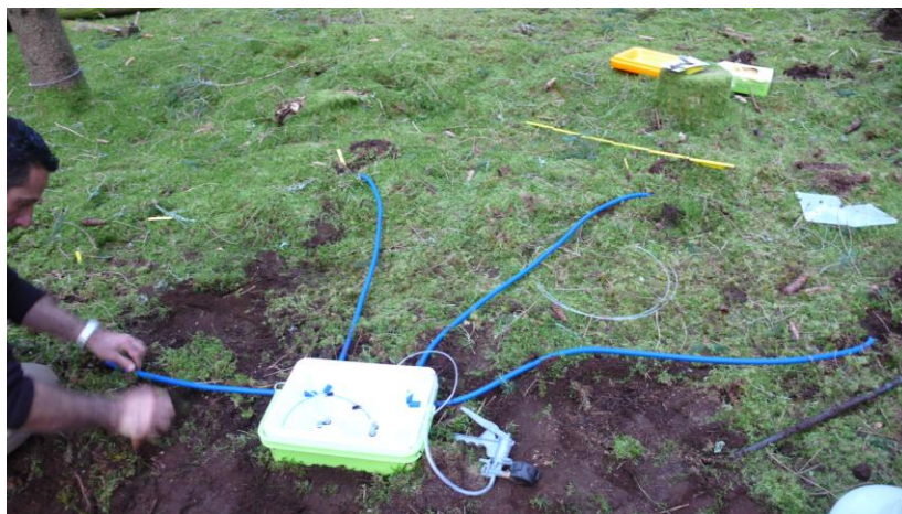
Figure 2. 5. Mise en place in situ de bougies poreuses. Dans la glacière, chaque flacon est connecté à deux bougies. Placette EPC 63.
