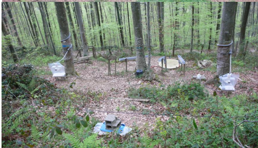
Figure 2. 7. (a) Gouttières pour la collecte des pluviolessivats ou Pluies Sous Couvert (PSC). Placette EPC 08. (b) Préleveurs pour les Ruissellements de Tronc et gouttières pour la collecte des pluviolessivats. Placette HET 64.
