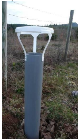
Figure 2. 6. Jauge d'Owen destinée à la collecte des Pluies Hors Couvert (PHC). Placette SP 11.
