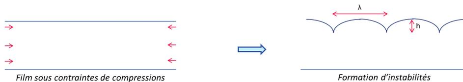
FIGURE 1.17 – Schéma de la formation d'instabilités de gonflement : sous contraintes de compression, des instabilités de longueur d'onde  $\lambda$  et de hauteur  $h$  se forment.
