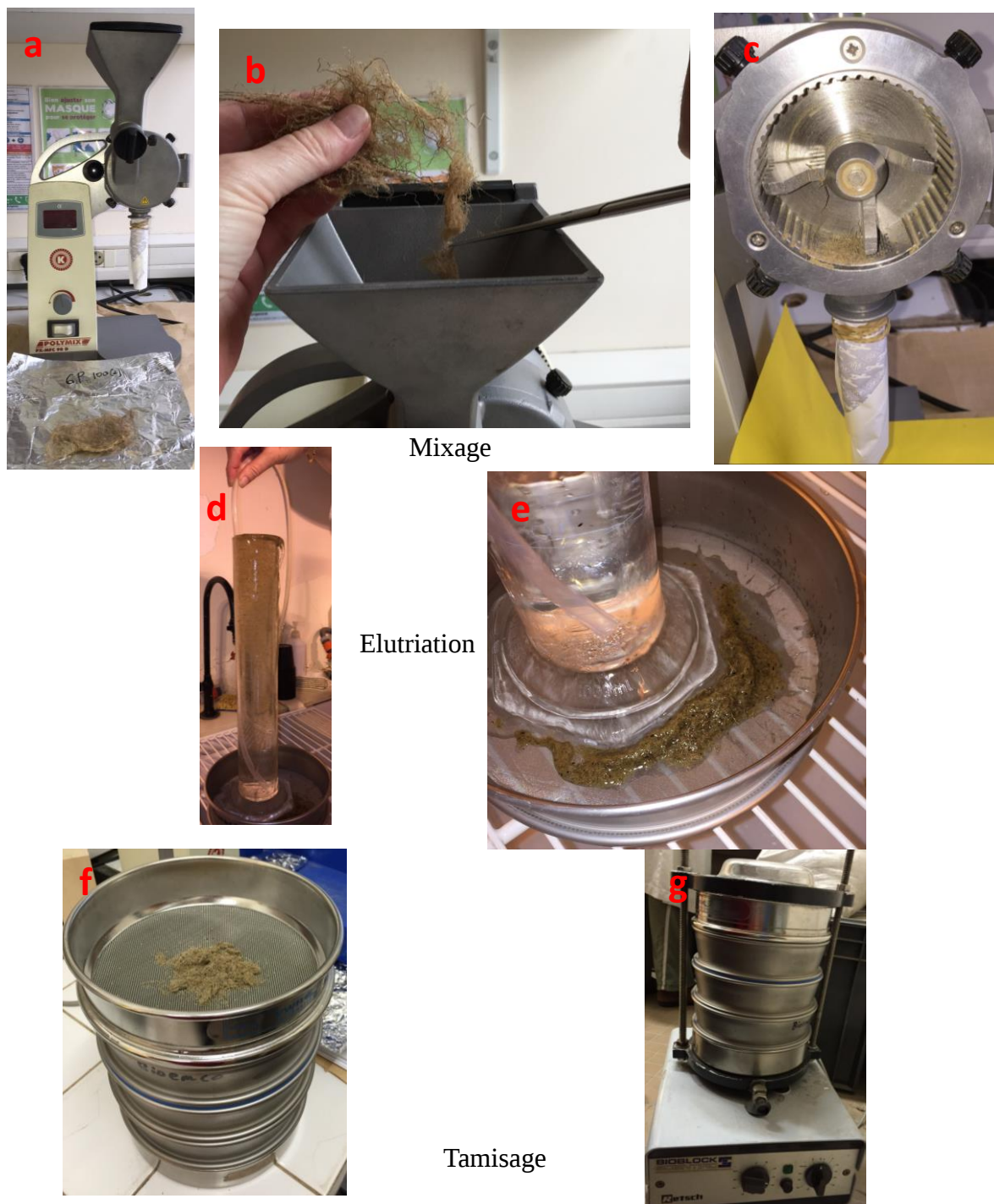
Figure 15 : Illustration des différentes étapes de classification des racines. (a) préparation des racines pour le mixage, (b) coupe des racines, (c) mixage, (d) mise en éprouvette et (e) récupération des racines par débordement, (f) et (g) tamisage.
