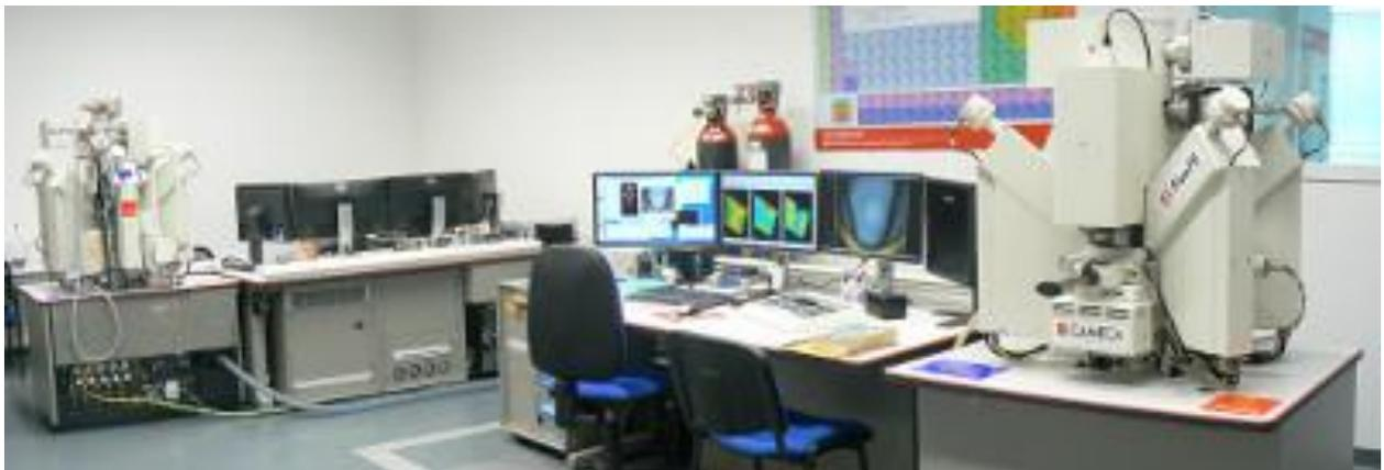
*Figure 20: Photo de la Microsonde Electronique CAMECA SXFive en service au centre de Microcaractérisation Castaing de Toulouse*
