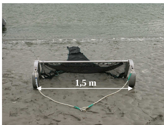
Figure 22 : Chalut à perche utilisé pour l'échantillonnage des juvéniles de flet (5-10 cm). Il possède une ouverture horizontale de 1,5 mètre, une ouverture verticale de 0,4 mètre et un maillage en trois parties d'un maillage de 5 à 10 mm.
