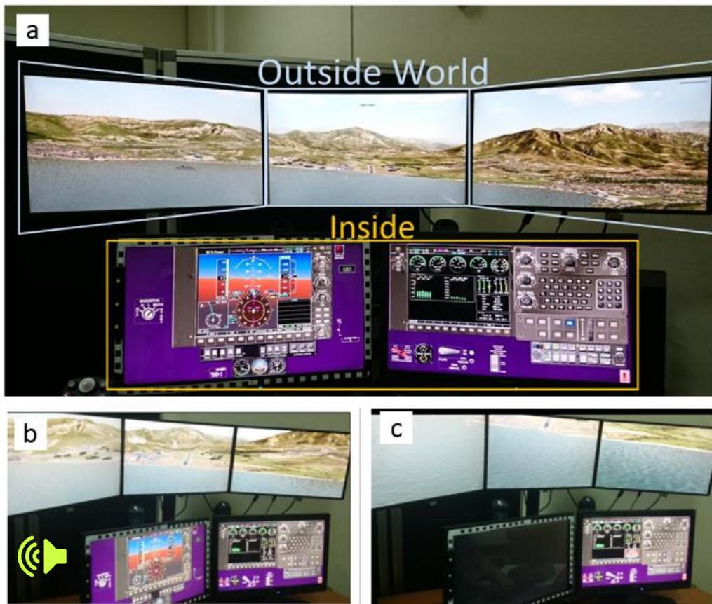
Figure 26 – (a) Photographie du simulateur avec la description des deux zones d'intérêt principales. (b) Photographie du simulateur lors du déclenchement de la notification sonores symbolisée par le haut-parleur. (c) Photographie du simulateur lors de l'apparition de la notification visuelle cachant l'écran du PFD (écran en bas à gauche).
