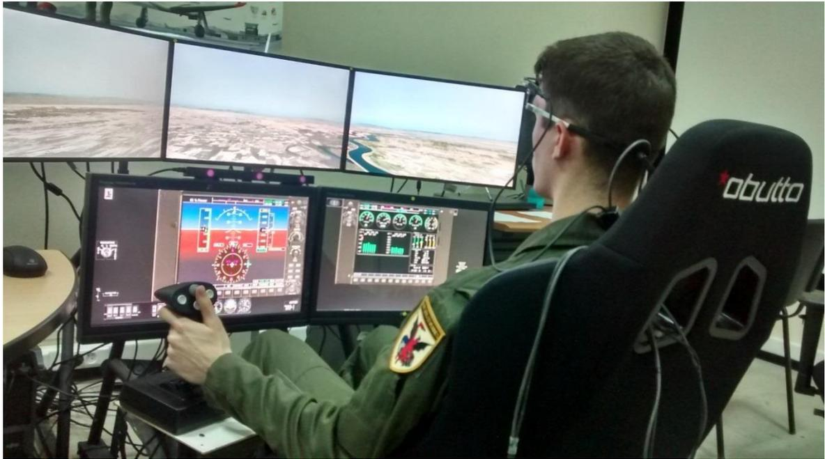
Figure 49 – Photographie d'un cadet-pilote (fin de la phase 1 de la formation de pilotage de l'Armée de l'air) en train de participer à cette expérimentation, aux commandes du simulateur de Cirrus SR20 et équipé de l'eye tracker Perteck®.
