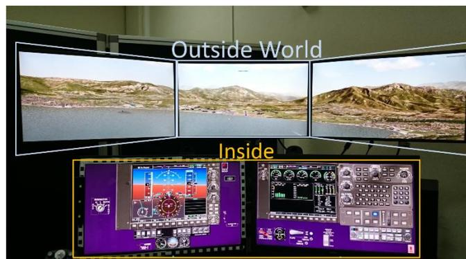
Figure 22 - Photo du simulateur SR20, avec la visualisation extérieure pour chercher les dangers extérieurs et le cockpit pour vérifier les paramètres de vol
