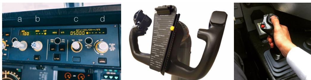
Figure 3. A gauche, Flight Control Unit (FCU) de l'Airbus A320. Au milieu, Yoke standard produit par Boeing. A droite, Sidestick standard produit par Airbus.
