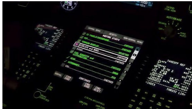
Figure 9. « Before Start » checklist affiché sur l'écran multifonction du piédestal du Boeing 777.
