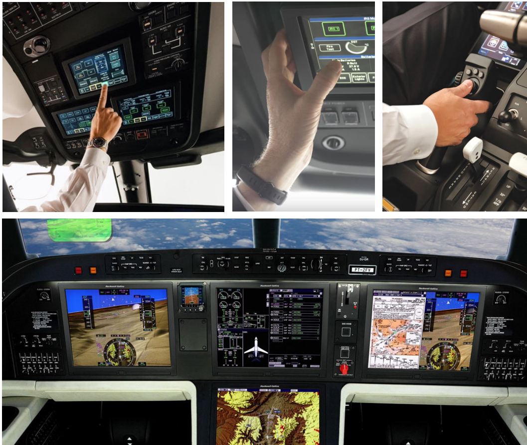
Figure 18. Rangée du haut, Symmetrie Flight Deck par Gulfstream basé sur la série Primus Epic de Honeywell, certifié en 2014 par la FAA pour le Gulfstream G500, un avion d'affaire à deux pilotes (à gauche, une vue d'ensemble ; au milieu, détail sur les rebords pour saisir la surface ; à droite, une commande de contrôle physique des MFD). Rangée du bas, Pro Line Fusion par Rockwell Collins, certifié en 2014 par la FAA pour le Legacy 500, un avion d'affaire à deux pilotes.
