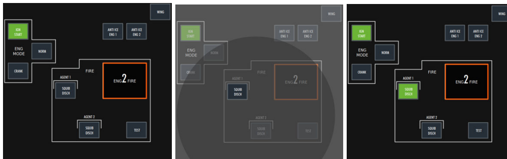
Figure 101. États du BraceTouch. A gauche, état Idle, au milieu, état Pressed et à droite l'état Clicked.
