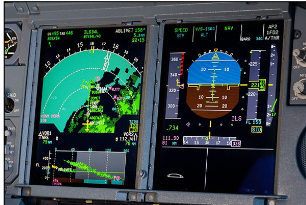
Figure 6. Navigation Display (ND) affiché à la gauche du PFD de l'Airbus A380.
