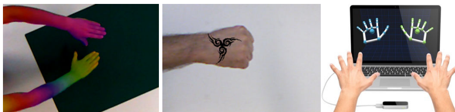
Figure 52. A gauche et au milieu, texture ajoutée de gradient de couleur puis tatouage par Genest et al., 2013 ; A droite, représentation du squelette des mains avec le dispositif leapmotion.
