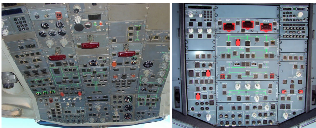
Figure 14. A gauche, le panneau en tête haute de l'A310 (1 ère génération de glass cockpit). A droite, celui de l'A320 (2 ème génération de glass cockpit).
