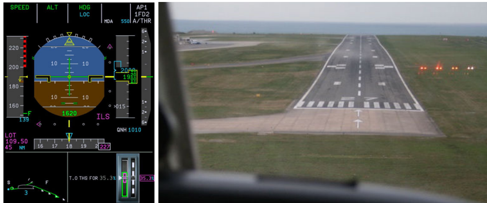
Figure 4. A gauche, interface du Primary Flight Display (PFD) de l'Airbus A380. A droite, système PAPI.
