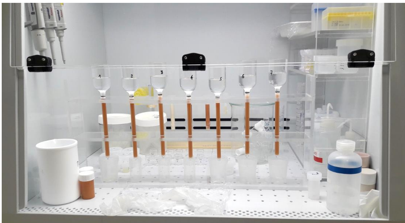
Photo 2.2: Hotte de salle blanche et matériel de géochimie. Au premier plan sont présentées les colonnes de séparation des éléments majeurs et traces avec résine AG50W-X8, 14 ml. L'objectif était d'isoler les terres rares des météorites publiées dans l'article Israel et al., 2020. Crédit C. Israel
