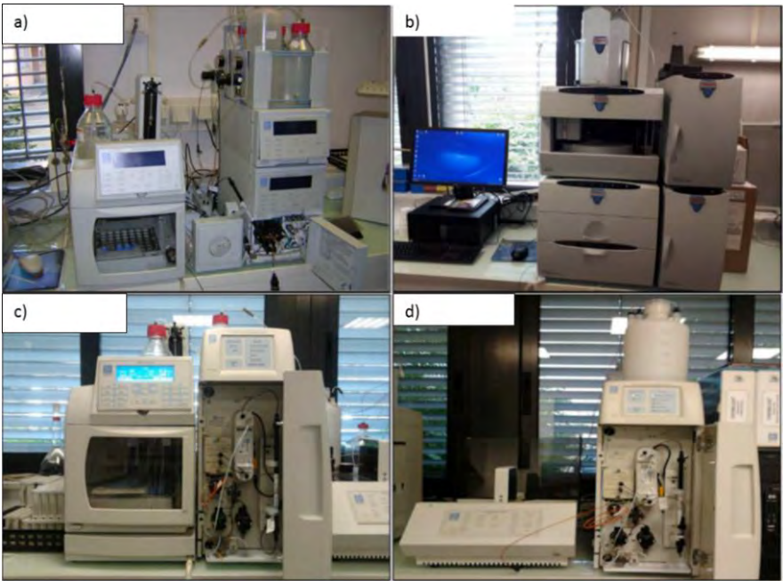
Figure II. 18: L'ensemble des chromatographes ioniques Thermo Dionex utilisés pour l'analyse des échantillons dans le cadre du programme DACCIIWA : a) ICS 1100, b) ICS 1000, c) DX 500 et d) ICS 5000.
