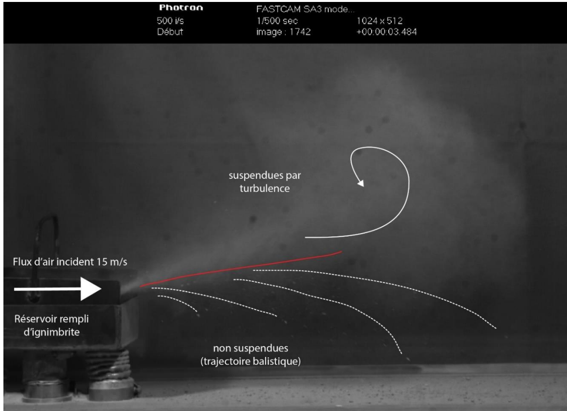
Figure 6.5 : Illustration de la ségrégation granulométrique opérée dans les expériences (ignimbrite de Neschers) juste après l'entraînement des particules par le flux d'air incident ( 15 \text{ m s}^{-1} pour cette expérience). Au-dessus de la ligne rouge les particules fines sont suspendues par turbulence et forment un nuage dilué, en-dessous de la ligne les particules ne sont pas suspendues dans l'air et chutent en adoptant une trajectoire balistique. L'image a été enregistrée par la caméra HV à 1.6 s après l'ouverture du flux d'air.
