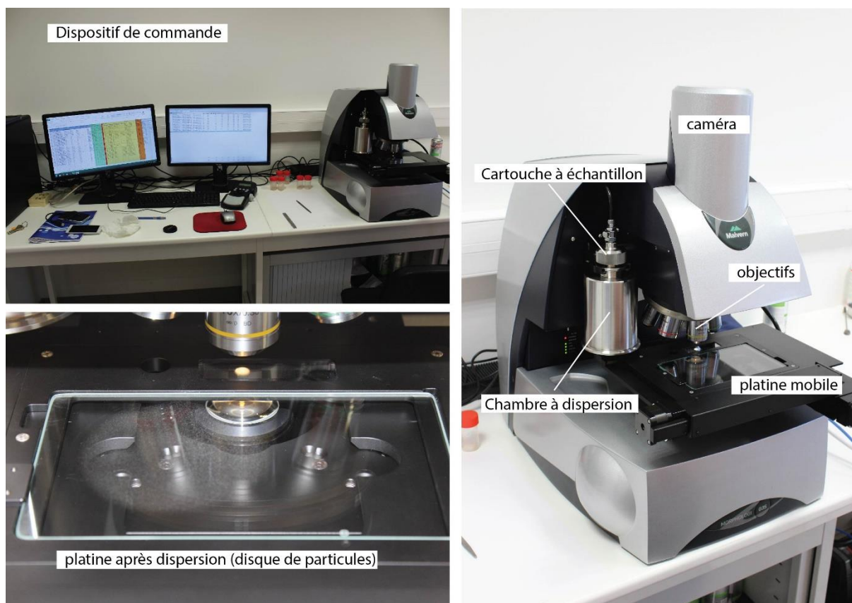
Figure 3.12 : Photos de l'analyseur Morphologi G3 utilisé pour mesurer la distribution de taille de grains des particules utilisées dans les expériences. L'appareil (à droite) est couplé à un ordinateur (en haut) pour effectuer les analyses. Avant chaque mesure, l'échantillon est dispersé dans une cloche et vient se déposer de façon uniforme sur la platine (en bas à gauche).
